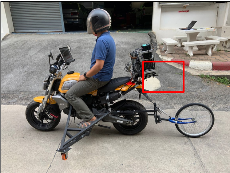
รูปที่ 1 การติดตั้งเครื่องมือวัดการเคลื่อนที่บนรถจักรยานยนต์
