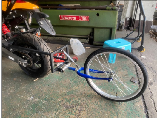
รูปที่ 2 อุปกรณ์การสร้างแรงกดที่ล้อเพื่อให้ตะพืดของเครื่องมือวัด
